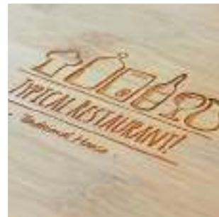
Utilisation d'un faisceau laser de haute précision, permettant une gravure en faible relief. Ce laser peut être à fibre optique, adapté aux métaux, ou à CO2, adapté au bois et au liège, ou à UV, adapté au verre.
