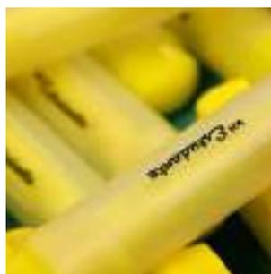
Technique idéale pour les petits objets et les formes arrondies, car le transfert de la peinture se fait à travers d'un tampon en silicone qui s'adapte à eux.
